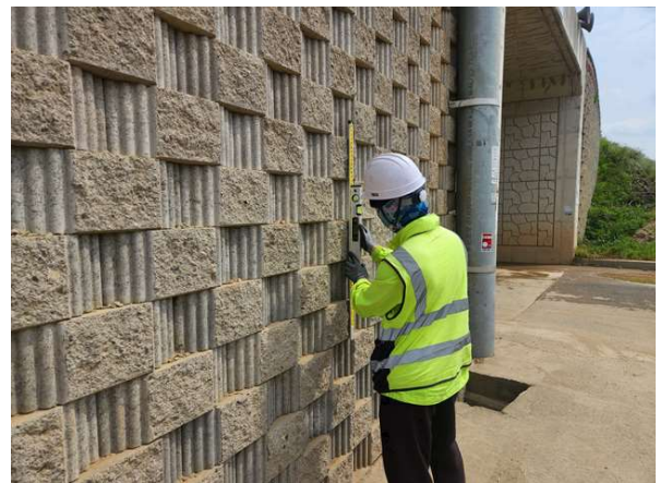
경사계를 이용한 경사도 측정
